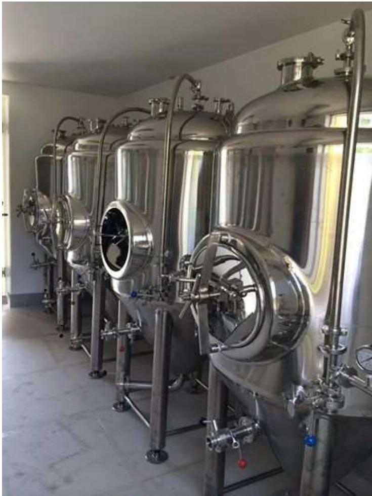
Humleland i Risskov er i gang med en større ombygning, der forøger bryggeriets kapacitet markant. Der er tale om et soldrevet nano anlæg. Bryganlægget er på 400 liter øl. Gærtankene er på 570 liter.
